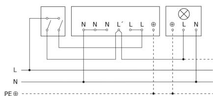
**Schaltplan Anschluss über einen Wechselschalter für Dauerlicht- und Automatik-Betrieb**
